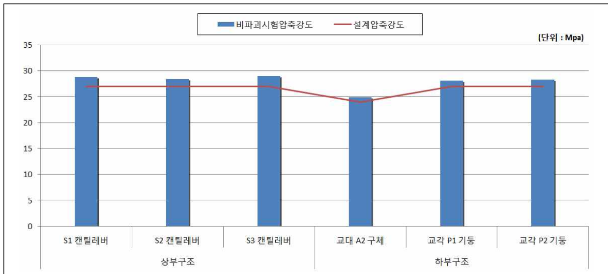
【그림 2.10.6】 콘크리트 강도시험 결과
